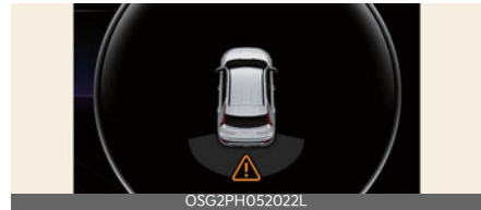
A: Ultrasonic sensor error or blockage
